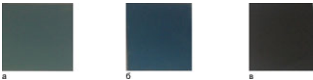
Рис. 3. Изменение синего цвета тонкой пленки стекла в зависимости от порядка интерференции (а – 1-й порядок; б – 2-й порядок; в – 3-й порядок)
